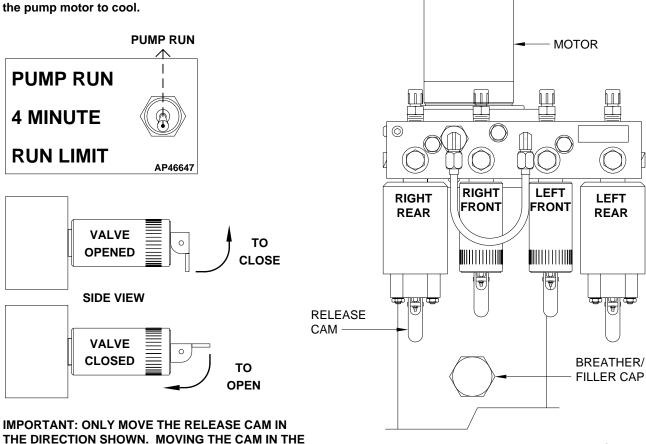
THE DIRECTION SHOWN. MOVING THE CAM IN THE OPPOSITE DIRECTION CAN DAMAGE THE VALVE.
