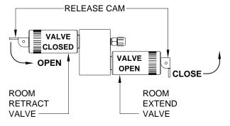
IMPORTANT: ONLY MOVE THE RELEASE CAM IN THE DIRECTION SHOWN. MOVING THE CAM IN THE OPPOSITE DIRECTION CAN DAMAGE THE VALVE.
