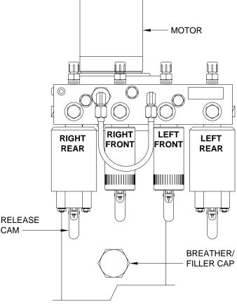
IMPORTANT: ONLY MOVE THE RELEASE CAM IN THE DIRECTION SHOWN. MOVING THE CAM IN THE OPPOSITE DIRECTION CAN DAMAGE THE VALVE.
