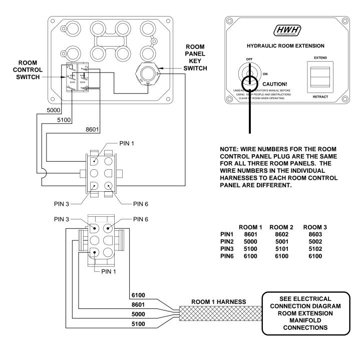
6100 - +12V FROM THE PUMP RELAY TO THE ROOM PANEL KEY SWITCH 8601 - 2 - 3 - +12V FROM THE ROOM CONTROL SWITCH TO THE SAFETY RELAYS FOR PUMP CONTROL 5000 - 1 - 2 - +12V FROM THE ROOM CONTROL SWITCH TO THE ROOM EXTEND SOLENOID VALVE 5100 - 1 - 2 - +12V FROM THE ROOM CONTROL SWITCH TO THE ROOM RETRACT SOLENOID VALVE
